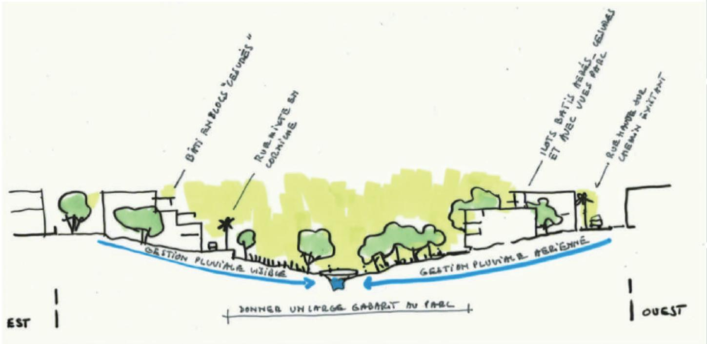
En adaptant le bâtiment à la topographie du terrain existant, non seulement on permet une gestion des eaux pluviales de façon gravitaire mais on économise aussi de lourds frais de terrassement.
